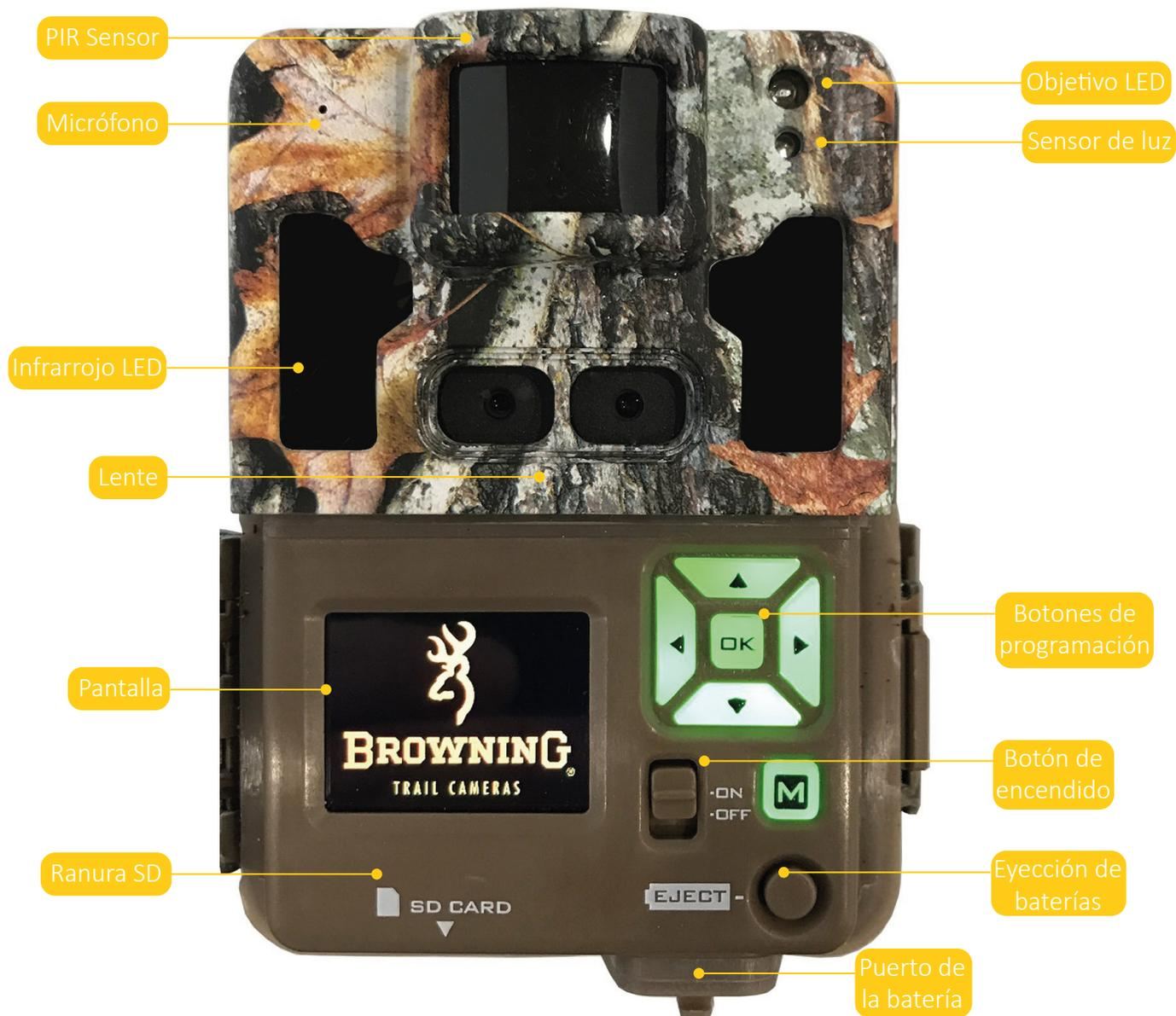
Figura 2. Partes de la cámara Browning Dark Ops HD Pro.
